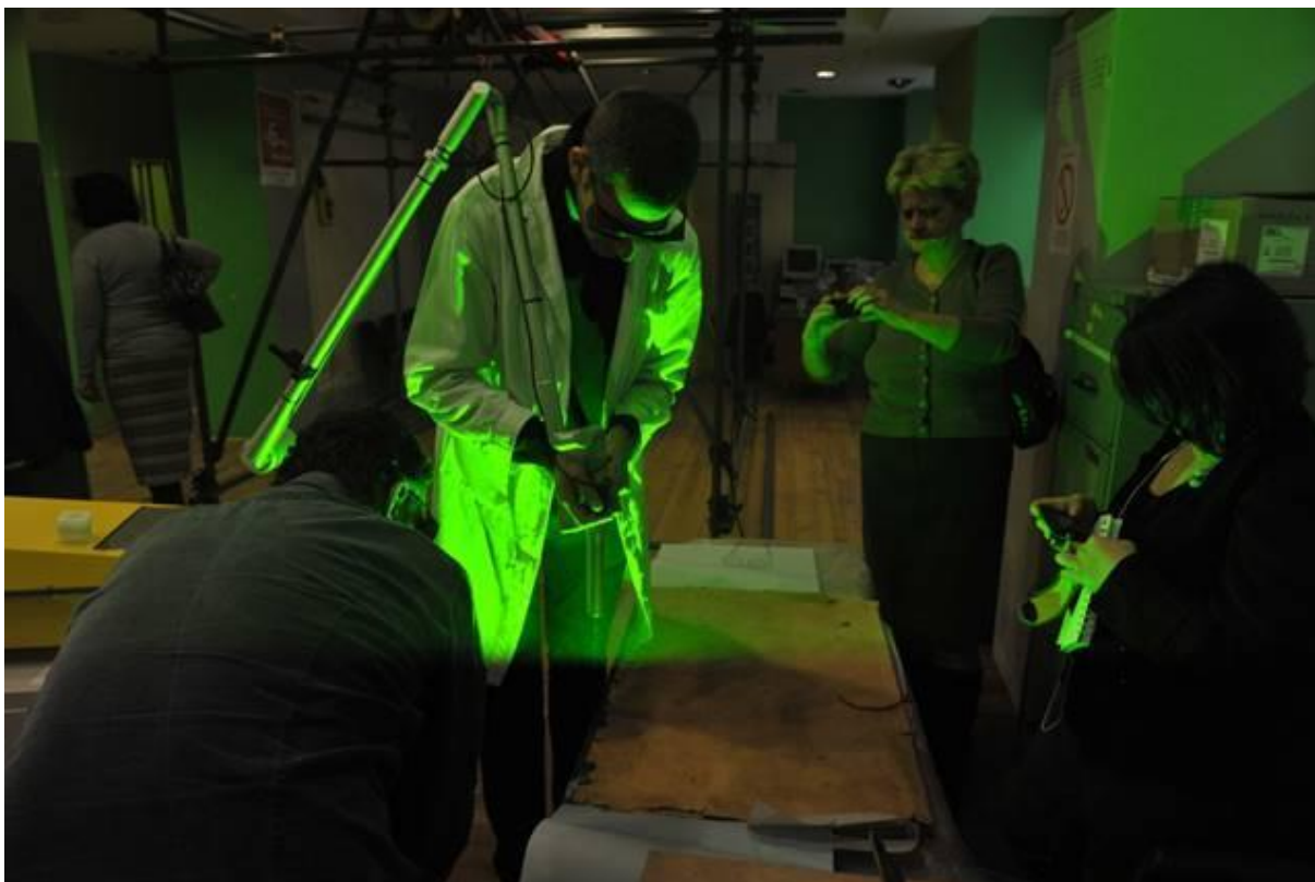
Laboratorija za multidisciplinarna istraživanja u CIK-u (saradnja konzervatora Arhiva Jugoslavije sa stručnjacima CIK-a –primena lasera u konzervaciji papira)
